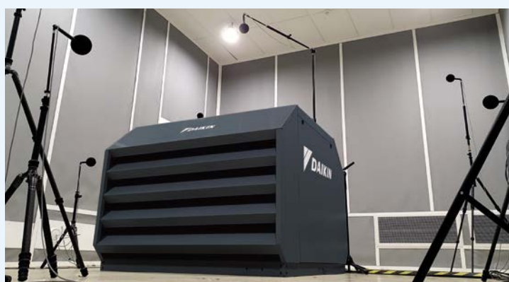
Pomiar poziomu mocy akustycznej w komorze akustycznej
